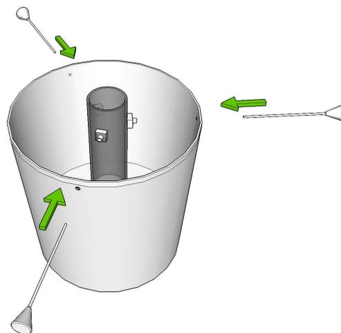
Более длинная относительно втулок часть цилиндра при этом должна быть направлена внутрь ёмкости так, чтобы при наливании в ёмкость воды край цилиндра погрузился в неё на 2 см.
